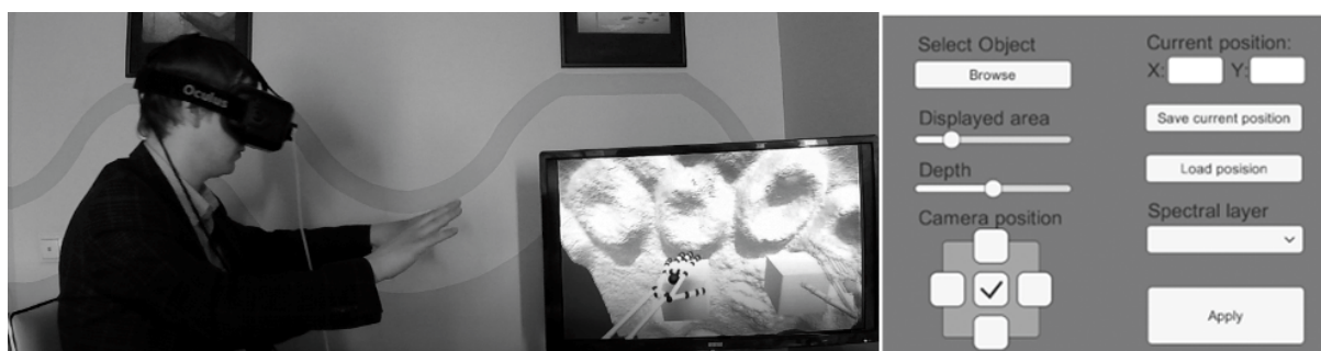
Рис. 2. Оператор рассматривает фазовый профиль эритроцитов, полученных методов гиперспектральной голографии, в среде виртуальной реальности; справа меню управления сценой
