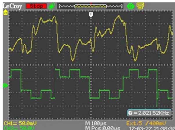
а) оциллограммы управляющего напряжения (нижняя) и фазовой задержки (верхняя)
