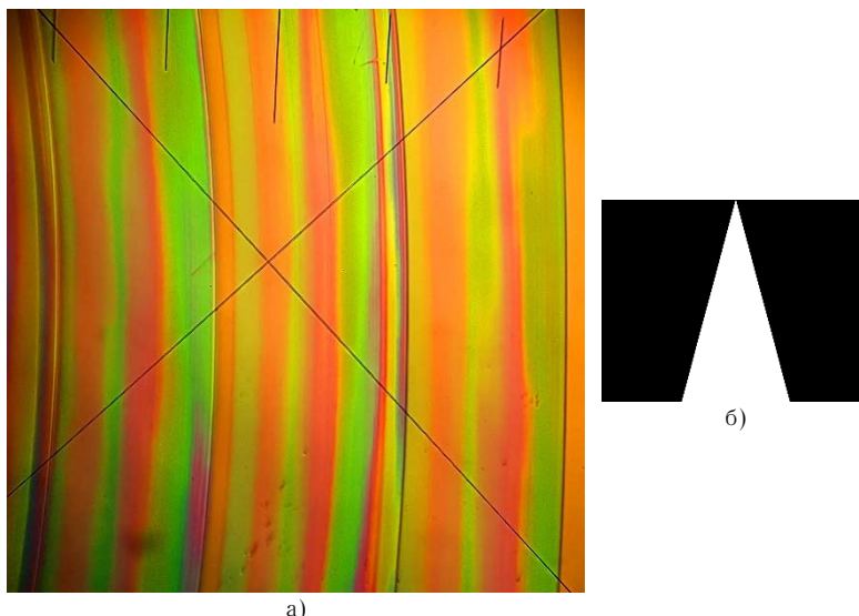
Рис. 1. Участок спиральной линзы Френеля (а) и форма сканирующего фрейма вблизи центра (б) в том же масштабе
