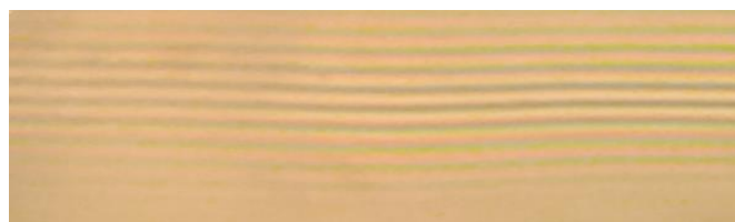
б) реплицированная поверхность (с использованием малоусадочной фотополимерной композиции)
