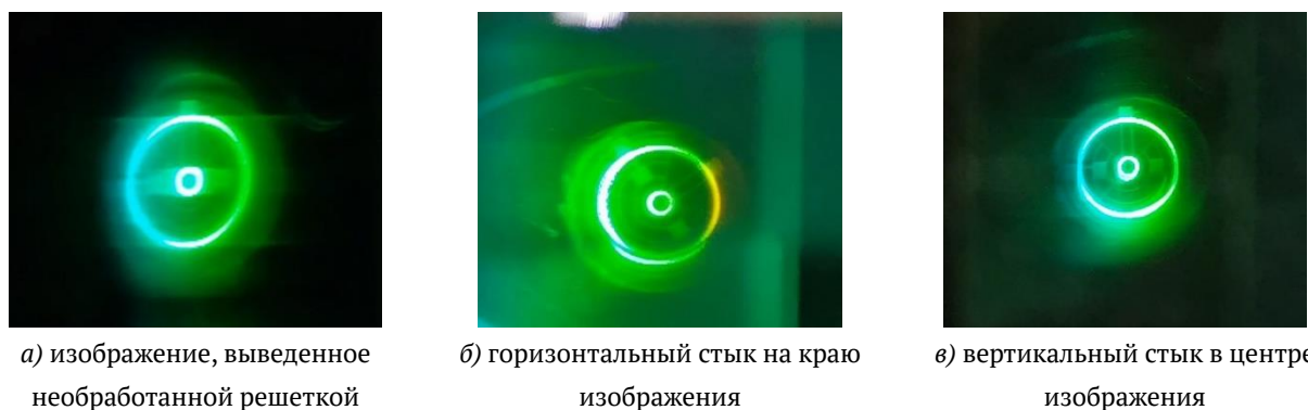
Рис. 2. Фотография изображения, выводимого системой в различных частях ИЛСа
