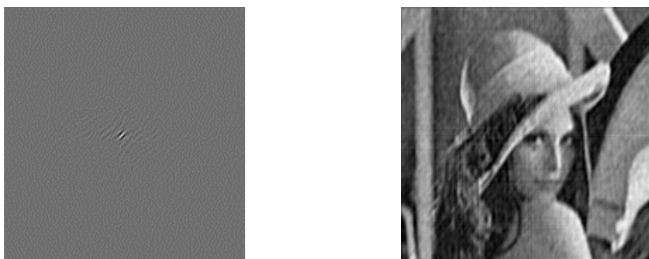
а) центральная часть голограммы б) изображение, восстановленное по голограмме Рис. 1. Результаты синтеза и компьютерного восстановления голограммы Фурье для изображения «Лена»
