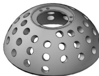
б) пример конструктивного размещения некогерентных коллимированных источников излучения
