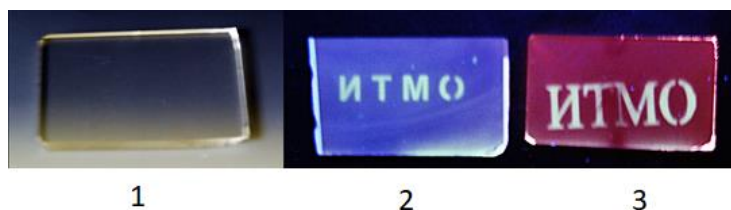
а) Исходный образец до УФ облучения (1), образцы при УФ облучении: классическое ФТР стекло (2), ФТР стекло, активированное европием (3);
