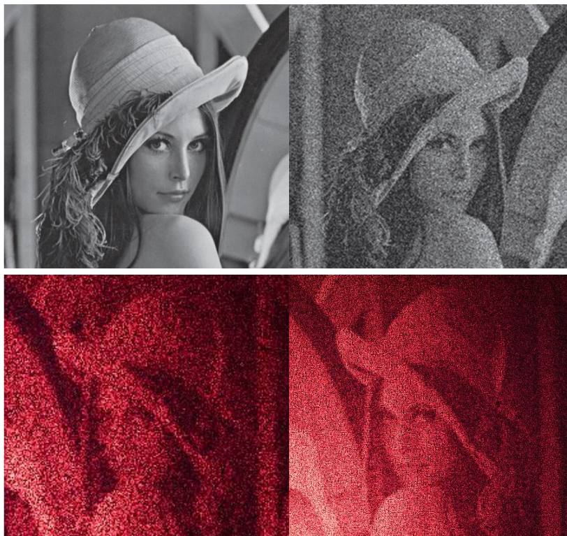
Рис. 2. К бинаризации и мультиплицированию голограмм. Верхний ряд: слева численно восстановленное с компьютерно синтезированной голограммы Фурье изображение; справа изображение, численно восстановленное с той же голограммы Фурье, бинаризованной методом Бредли. Нижний ряд: результат оптического восстановления бинаризованной голограммы выведенной на МЗ ПВМС и результат оптического восстановления такой же мультиплицированной голограммы, выведенной на МЗ ПВМС (использован МЗ ПВМС Discovery DLP9500BFLN)
