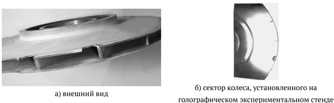
Рис. 1. Рабочее колесо центробежного компрессора с разрушениями покрывного диска
