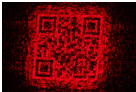
Рис. 4. Результат оптической реконструкции бинарного амплитудного ДОЭ нового типа
