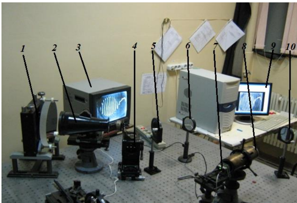
1 — плоское образцовое зеркало; 2 — испытуемый ИК-объектив; 3 — монитор; 4 — формирующий объектив; 5 — светоделитель; 6 — плоское опорное зеркало; 7 — регистрирующая камера; 8 — сопрягающий панкратический объектив; 9 — персональный компьютер; 10 — плоское ломающее зеркало; CO 2 -лазер размещен под оптическим столом
