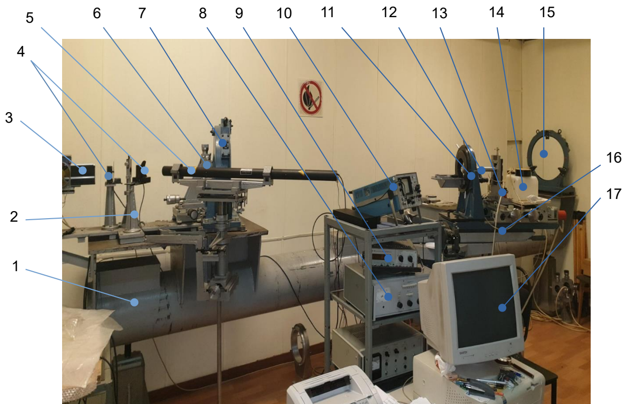
1 — станина; 2 — узел переключающего зеркала; 3 — CO 2 -лазер (10,6 мкм); 4 — модуляторы; 5 — He-Ne-лазер (3,39 мкм); 6 — узел конденсора и тест-объектов; 7 — узел ломающего зеркала; 8 — усилитель; 9 — аналогово-цифровой преобразователь; 10 — осциллограф; 11 — объективодержатель; 12 — анализатор изображения; 13 — трехкоординатный позиционер; 14 — резервуар с дистиллированной водой; 15 — узел коллиматорного зеркала; 16 — поворотное устройство; 17 — персональный компьютер
