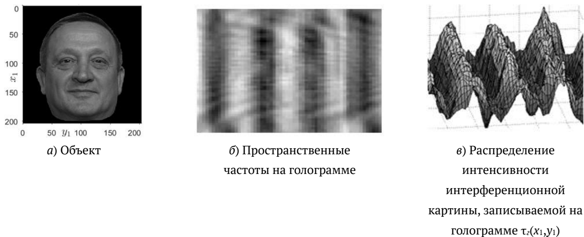
Рис. 2. Запись голограммы реального объекта
