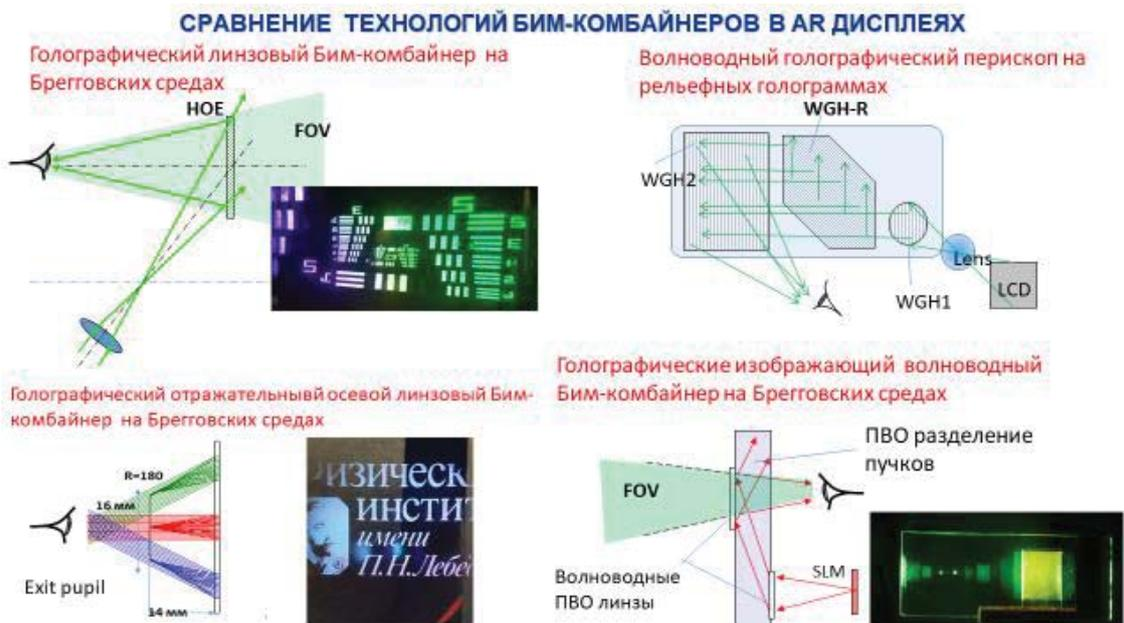
**Рис. 2.** Технологии изготовления голографических бим-комбайнеров
