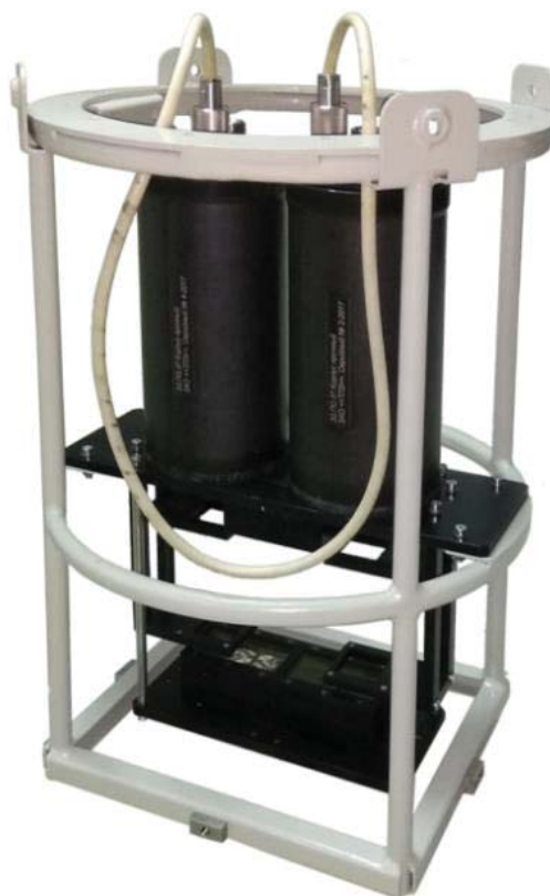
б) фотография ДНС в сборе, модули в герметичных прочных корпусах
