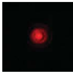
в) микрофотография кружка рассеяния этой линзы ( \lambda = 632,8 нм, диаметр кружка рассеяния — 4 мкм, увеличение \sim 1000\times )
