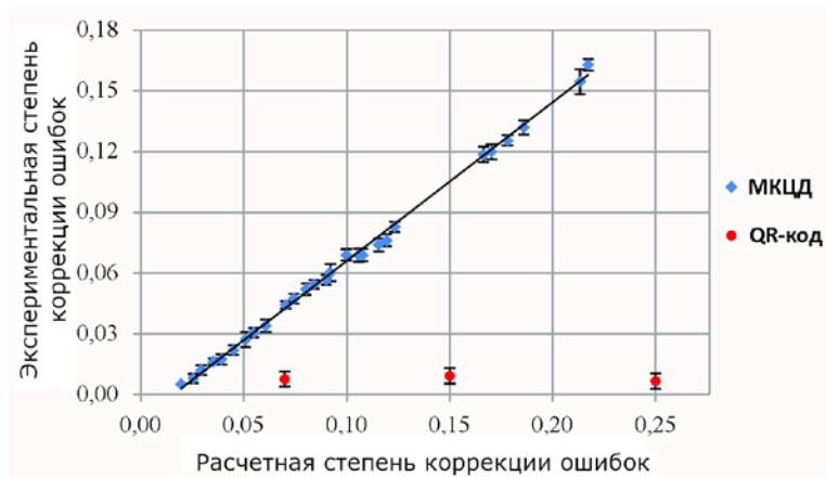
Рис. 4. Зависимость значения экспериментальной степени коррекции ошибок от величины расчетной степени коррекции ошибок
