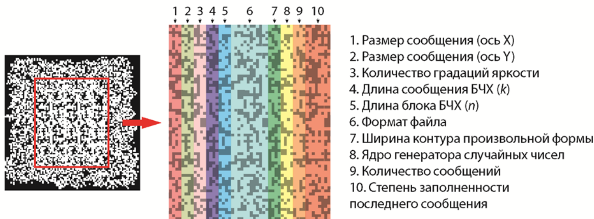
Рис. 3. Кодированный служебный блок МКЦД и его составные элементы
