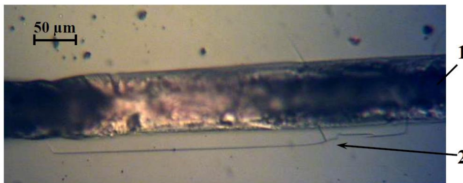
Рис. 3. Фотография поверхности оксидной пленки с напыленной дорожкой алюминиевой металлизации после прохождения одиночного токового импульса удельной мощностью P=3,4 \cdot 10^5 Вт/м 2 и длительностью \tau=500 мкс.
