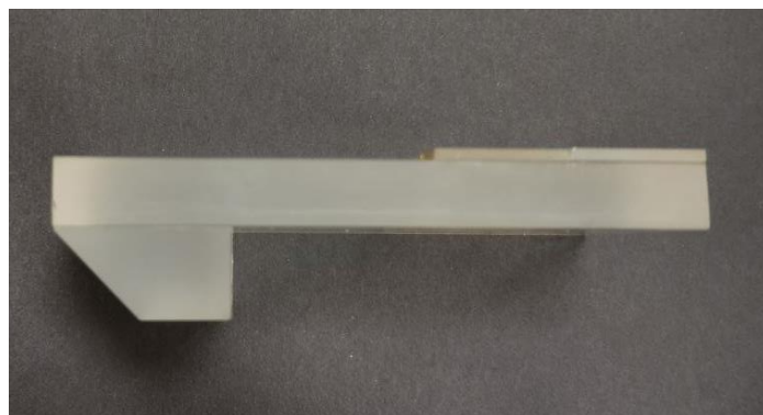
Рис. 1. Фотография макетного образца ИЛС с 4 сегментами из ФТР стекла в зоне вывода
