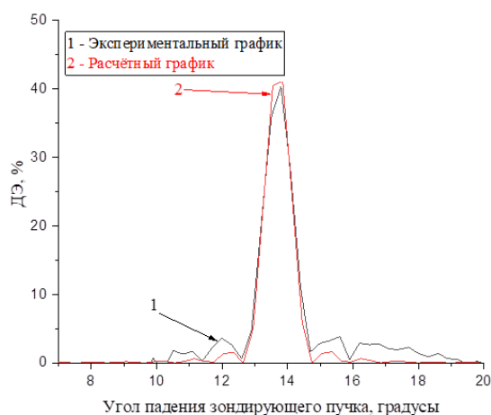
Рис. 2. Спектр угловой селективности пропускающей голограммы с использованием КПЗ
